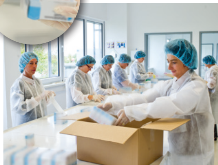
Endkonfektionieren im Herstellungsraum, oben: Bekleben mit Originalitätsverschlüssen
